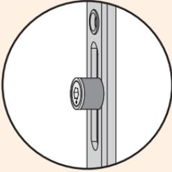
Höheneinstellung: zum Falzluftausgleich rollende Hülse in die Raststellung ziehen
